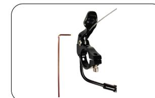
7. Ziehen Sie den Kabelzug straff und fixieren Sie die Schraube mit einem 2-mm-Inbusschlüssel.
