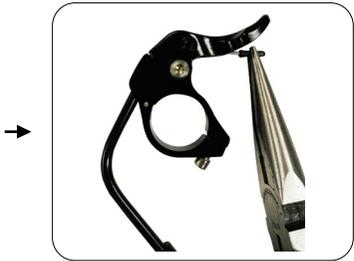
10. Schieben Sie das Kabel in die Führung unter dem Hebel, schneiden Sie das Kabel in geeigneter Länge ab und fixieren Sie das Kabelende.
