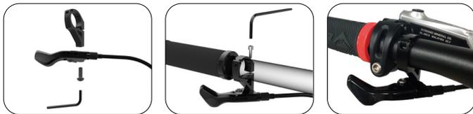
Hebel nur auf der linken Lenkerseite (linke Hand des Fahrers) montieren. Klemmhebel mit 3-mm-Innensechskantschlüssel um die Klemme am Lenker zu fixieren.
