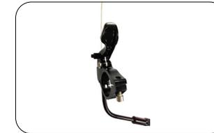
6. Stecken Sie die Mutter in den Hebel mit dem Schraubensatz auf der linken Seite des Hebels.
