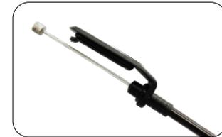
2. Führen Sie den Kabelzug durch die Zughülle (mit Endkappe) und befestigen Sie die Zughülle an der Unterseite der Abdeckung.
