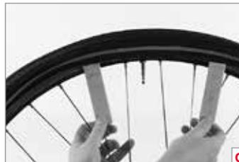
Bevor Sie den Reifen ganz in die Felge schieben, überprüfen Sie nochmals den Sitz des Schlauches und drücken Sie den Reifen dann mit dem Handballen über das Felgenhorn.
