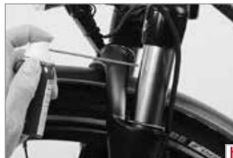
3. Besprühen Sie die Standrohre der Federgabel, nachdem Sie Ihr Fahrrad gewaschen haben, mit etwas lithiumfreiem Schmier spray **(h)** oder tragen Sie eine sehr dünne Schicht Hydrauliköl auf. Federn Sie die Gabel dann mehrfach ein und wischen Sie die Schmiermittelreste vor der nächsten Fahrt mit einem sauberen Lappen ab.
