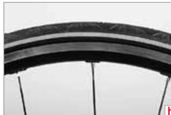
6. mit Reifen, deren Seitenwände **(h)** ringförmig zusammenhängend weiß oder gelb rückstrahlend sind, oder an jedem Rad mit nach beiden Seiten wirkenden Rückstrahlern oder Rückstrahlmaterialien, die den Bestimmungen der ECE-Regelung Nr. R 104 entsprechen, mit einer Lichteintrittsfläche von mindestens 20 cm<sup>2</sup>,
