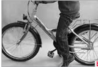
Wenn der Lenker zu weit vom Sattel entfernt oder zu hoch/zu tief positioniert ist, fährt das Kind ebenfalls unsicherer und weniger entspannt als es könnte. In der Regel lassen sich die waagerechte Position des Sattels, in vielen Fällen auch die Neigung des Lenkers verstellen.
