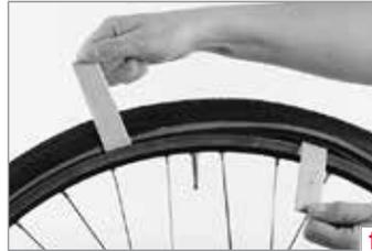
Ist ein Teil der Reifenflanke über den Felgenrand gehebelt, können Sie sie meist problemlos über den gesamten Umfang lösen, indem Sie einen Montierhebel verschieben. Nun können Sie den Schlauch herausnehmen. Passen Sie auf, dass das Ventil nicht in der Felge hängenbleibt und der Schlauch nicht weiter beschädigt wird. Die zweite Reifenflanke können Sie bei Bedarf einfach herunterziehen.
