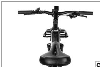
Quand tout est OK, commencez par serrer la vis avec une clé Torx T 25, puis avec une clé dynamométrique jusqu'à atteindre un couple de 5-6 Nm. Conformez-vous impérativement au couple de serrage indiqué.
