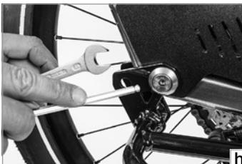
Amenez les attaches de fixation du protège-rayons devant les trous dans la base de votre CENTURION VARIO. Tenez l'extrémité du marchepied contre le trou arrière avec les deux attaches soudées parallèlement. Les attaches doivent être positionnées à droite et à gauche de la patte de fixation ou de la traverse du cadre.
