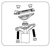
Demontieren Sie alle Klemmen vom oberen Kopf der Stütze.
