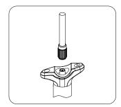
Verwenden Sie eine kompatible Dämpferpumpe und stellen Sie den gewünschten Druck ein.
