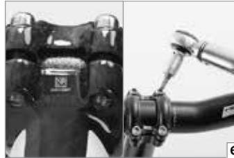
Nachdem Sie den Lenker eingestellt haben, müssen Sie die Brems- und Schaltgriffe justieren. Lösen Sie dazu die Innensechskantschrauben an den Griffen. Verdrehen Sie den Griff auf dem Lenker. Setzen Sie sich auf den Sattel und legen Sie Ihre Finger auf den Bremshebel.
