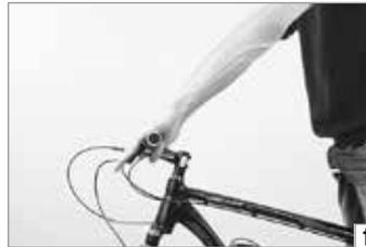
Überprüfen Sie, wenn Sie auf dem Rad sitzen, ob Ihre Hand mit dem Unterarm eine gerade Linie bildet **(f)**. Drehen Sie die Griffe mit einem Drehmomentschlüssel wieder fest und machen Sie eine Verdrehkontrolle **(g)**! Die Bremshebel müssen nicht absolut fest sein. Es ist vorteilhaft, wenn diese sich bei einem Sturz verdrehen können.
