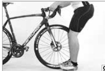
Um die Lenkerneigung einzustellen, öffnen Sie die Innensechskantschraube(n) an der Unter- bzw. Vorderseite des Vorbaus **(f)**. Verdrehen Sie den Lenker, bis er in der von Ihnen gewünschten Stellung ist. Achten Sie darauf, dass der Vorbau den Lenker genau in der Mitte klemmt.
