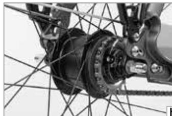
Bei **Nabenschaltungen (h)** und **Getriebeschaltungen** steht die „1“ für den ersten, leichtesten Gang. Die Gänge werden der Reihe nach, möglichst bei kurzem Stillstand der Pedale, zumindest aber bei vermindertem Pedaldruck durchgeschaltet. Die höchste Zahl bedeutet den höchsten Gang.
